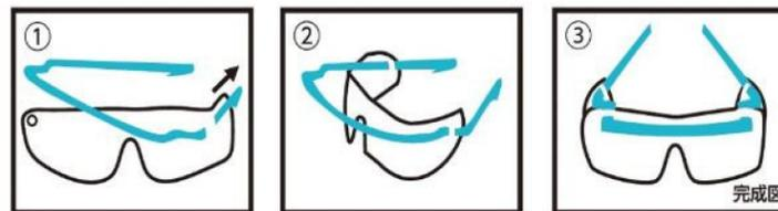
① 保護フィルムを外し、シールドを内側にして図のようにフレームを通します。
